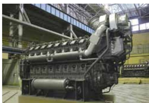
Фото 1. Дизель мощностью 4000 кВт для Белоярской АЭС перед отправкой на станцию
